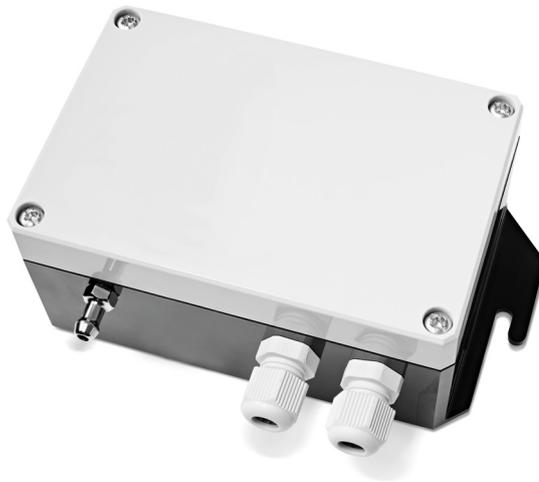
Mit Druckmessumformern der Typenreihe APS lassen sich Absolutdrücke nichtaggressiver Gase messen. Die Druckmessung erfolgt über das bewährte und robuste induktive Messverfahren. Dieses Messprinzip ermöglicht auch in niedrigsten Druckbereichen hochpräzise Messungen und bietet nebenbei eine sehr gute Langzeitstabilität.
